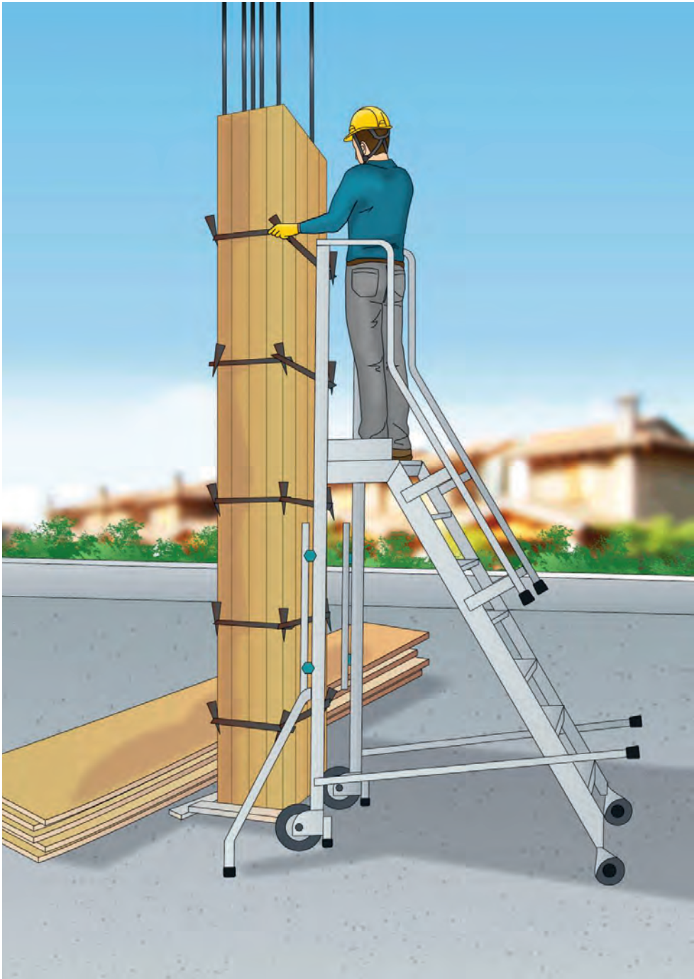
Figura 2 - Esempio di scala mobile con piattaforma, ai sensi della UNI EN 131-7
