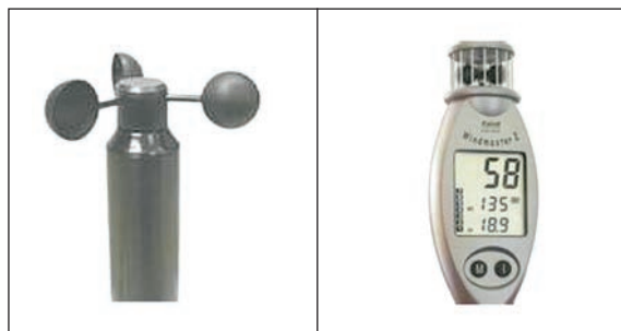
Figura 7 - Esempi di anemometri: fisso e portatile
